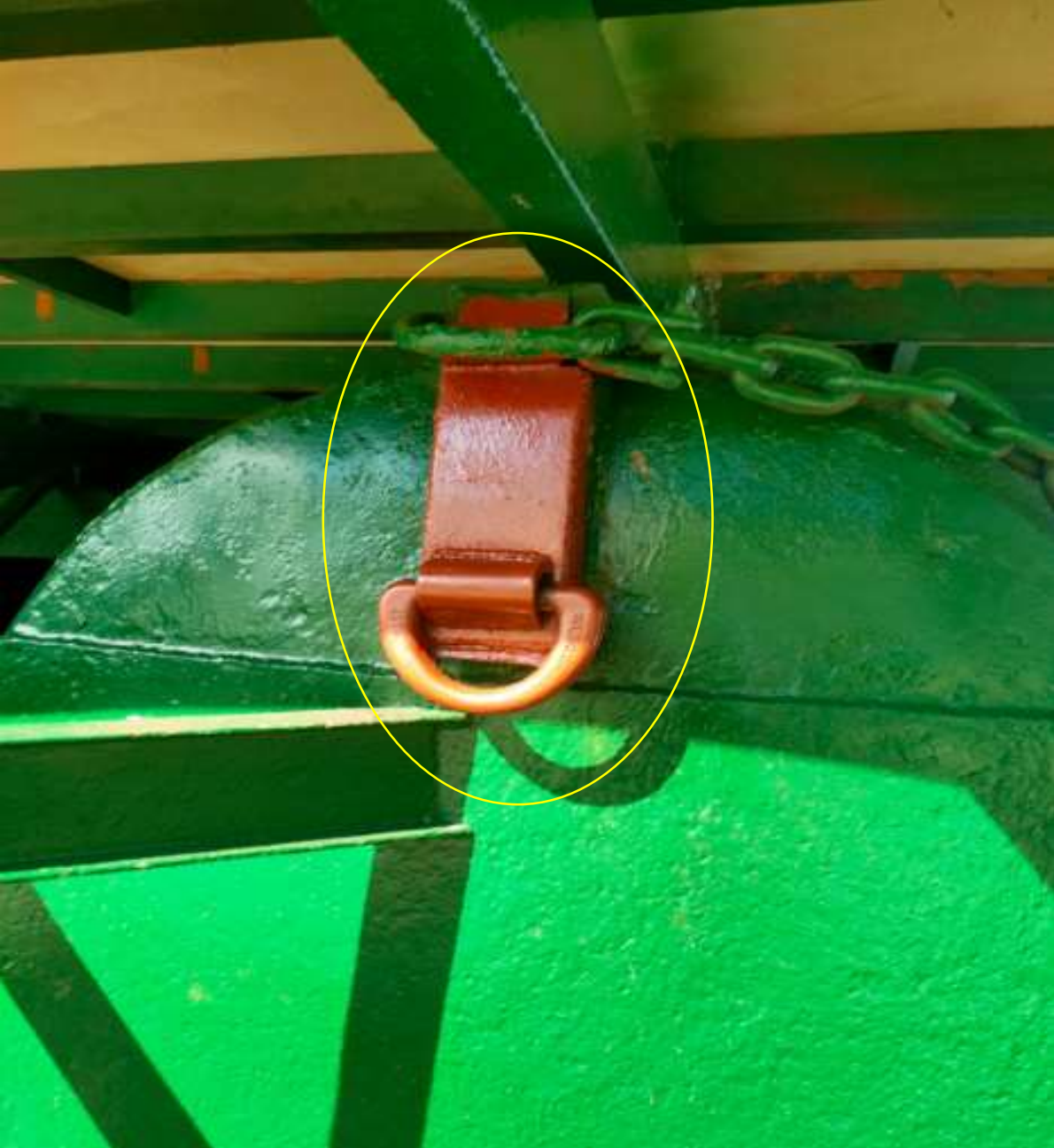
DABLİN VE HALKA KAYNAĞI İŞLERİ SONRASI ASTAR VE EPOKSİ BOYA UYGULAMASI GÖRSELLERİ
